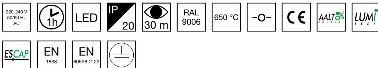
ESCAP-Rettungszeichenleuchte mit 1 h Superkondensator-Backup, kompatibel mit Aalto Control (inkl. Lumi Test - Selbsttest), mit 2-seitiges Piktogramm (Pfeil nach rechts/links), 30 m Erkennungsweite (einzeln verpackte TWS6892WA)
