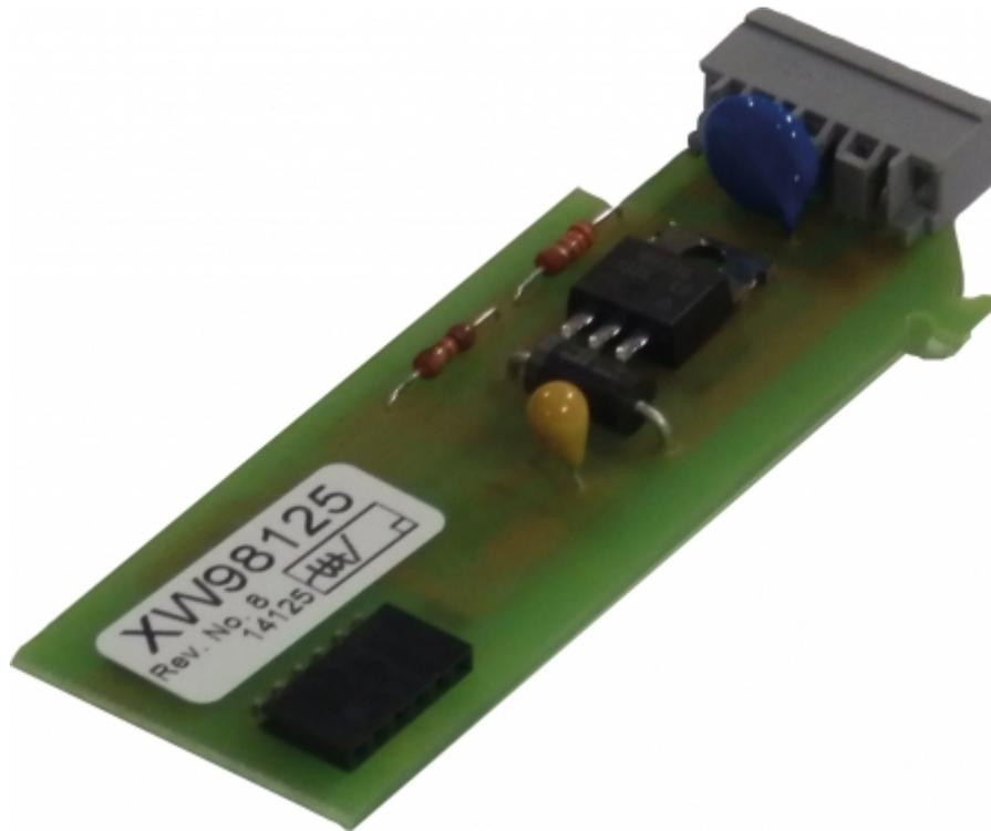
Output Circuit Board für TK23xxC Zentralbatteriesysteme (XW98125)
