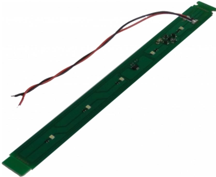
LED-Leiterplatte+Kabeln (XW89141E), für Esc20 (TW89141W, TW89151W)
