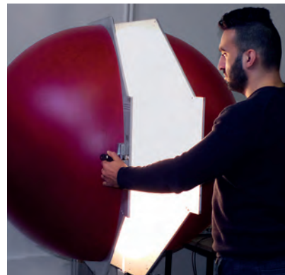
Ljusflödet från armaturerna mäts i Teknowares laboratorium med en Ulbricht-sfär.
